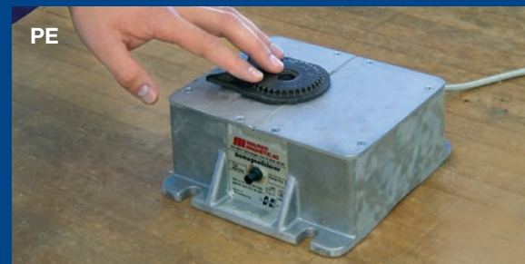
Mit einem klassischen Plattenentmagnetisierer lassen sich dünnwandige, flache Teile sicher entmagnetisieren.
