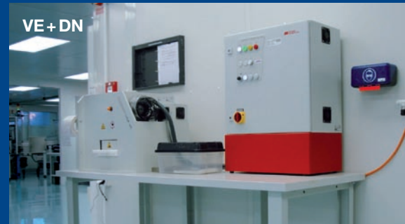
Entmagnetisierung von Injektionsnadeln in Behältern mit einem Puls von 7 Sekunden.
