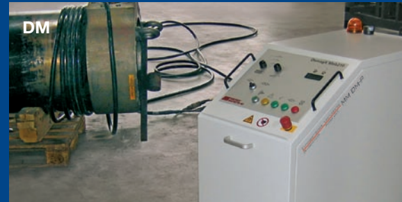
Grosse Einzelteile werden mit dem mobilen Entmagnetisierer DM200 entmagnetisiert. Mit der flexiblen Kabelspule kann jedes Teil geeignet umspult werden.
