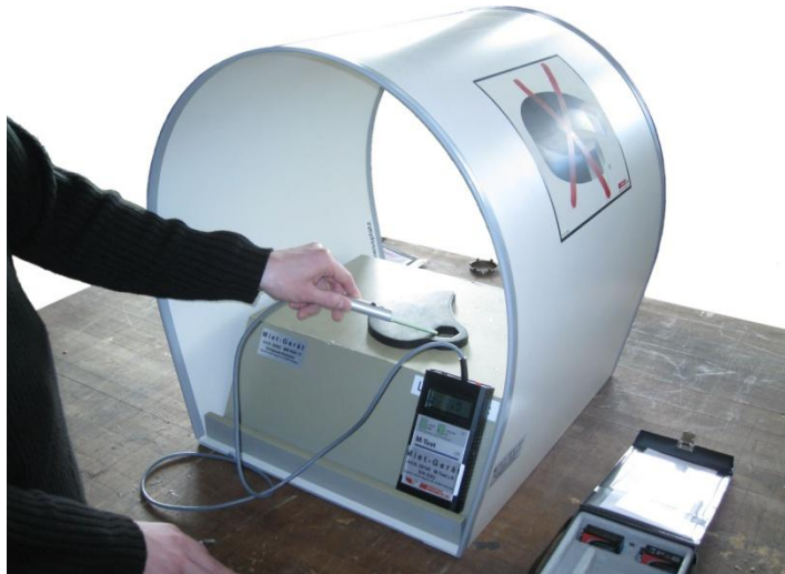
Instrumentenkoffer mit Messgerät, Zertifikat, Software, Referenzmagnet und Netzgerät
